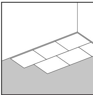
Lamelparket og laminatgulve kan lægges direkte ovenpå underlaget (gælder både 4 og 7 mm). Drejer det sig om gulvtæppe, PVC, linoleum eller andre former for gulv, er det endvidere nødvendigt med et lastfordelende underlag. 7 mm "Tæppe-kvalitet" er specielt udviklet til gulvtæpper
