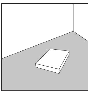
Dette underlag er et naturprodukt, det er derfor vigtigt at få det akklimatiseret (tilpasset rummets fugtighed mv.) inden nedlægning. Vi anbefaler at underlaget akklimatiserer min. 24 timer i selve rummet inden lægningen
